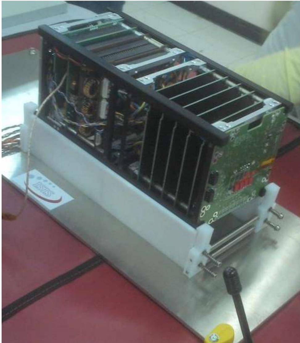
**Figura 2: Modelo de Engenharia do NANOSATC-BR2**
