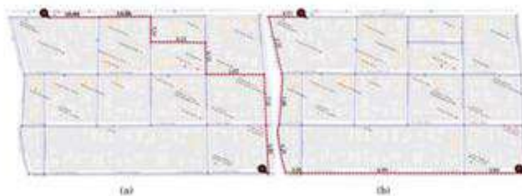
Figura 7. Testes utilizando as métricas apresentadas. (a) caminho calculado utilizando apenas distâncias como custo. (b) caminho levando em conta a inclinação.
