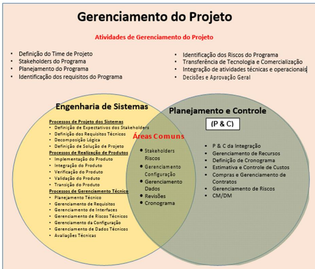
Figura 3.1- Processos técnicos de gerenciamento de projeto.
