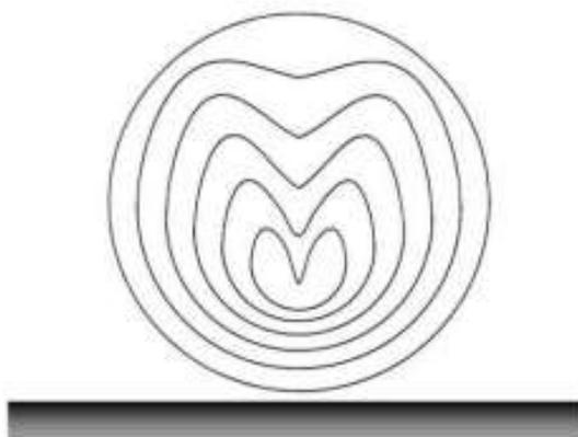
**Figura 2.2:** Formação de um micro jato líquido durante o colapso de uma bolha próxima a uma superfície sólida [1,14].
