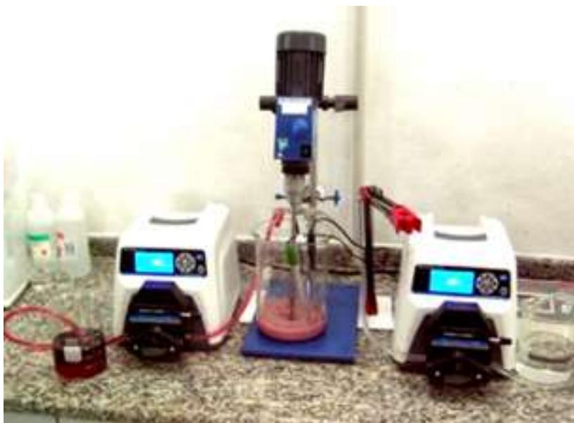
Figura 2 – Esquema utilizado para a síntese por coprecipitação
