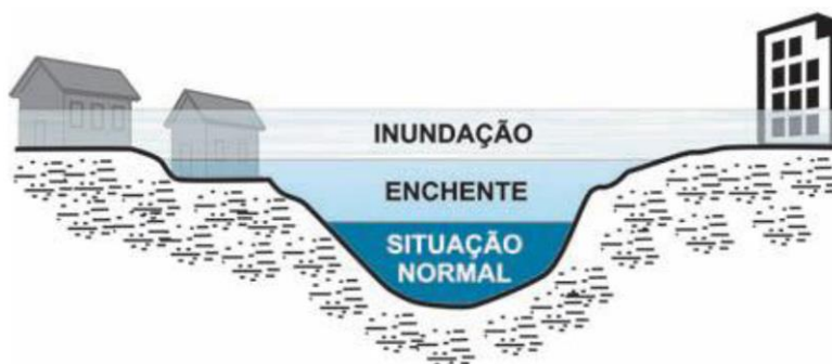
Figura 08 – Perfil esquemático do processo de enchente e inundação Fonte: Ministério das Cidades/IPT
