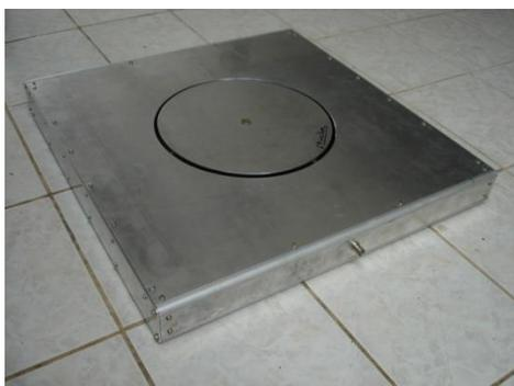
figura.1: Sensor de campo elétrico
