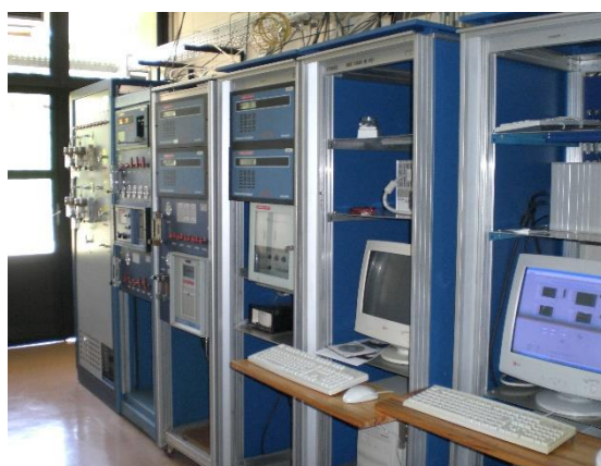
Figura 3 - Analisadores dos gases CO 2 , CO, NO e UHC.
