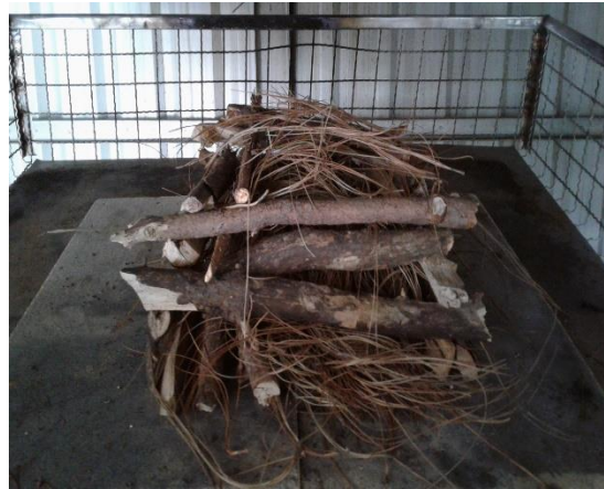
Figura 5 - Estrutura de troncos com diâmetro menor ou igual a 2,5 cm.
