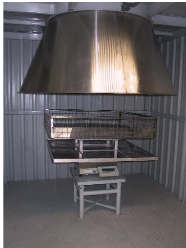
Figura 2 - Balança e prato para testes de biomassa, e boca da chaminé.
