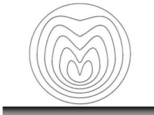
Figura 2.1 - Formação de um micro jato líquido durante o colapso de uma bolha próxima a uma superfície sólida <sup>(1,9)</sup>.
