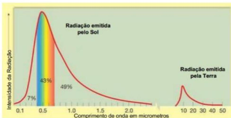
Figura 6 - Espectro de radiação eletromagnética emitida pelo Sol e pela Terra.
