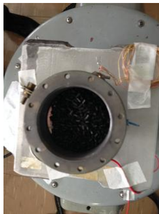
Figura 6 – Propulsor durante do carregamento
