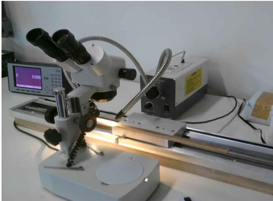
Figura 4. Imagem do estereomicroscópio e da mesa de medição Velmetr®
