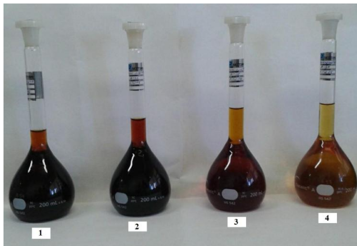
Figura 6 - Soluções das amostras dos catalisadores: (1) Ru/Al 2 O 3 (lote 1), (2) Ru/Al 2 O 3 (lote 2), (3) Ir- Ru/Al 2 O 3 e (4) Ir/Al 2 O 3
