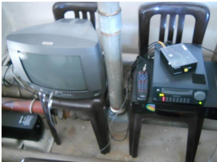
**Figura 4.** Equipamento utilizado para a gravação das imagens. À esquerda, uma TV, e à direita, de baixo para cima, videocassete, DVR e kiwi.
