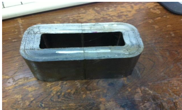
Fig. 2.1 - Núcleo Magnético Metglass AMCC 100 sem enrolamentos.
