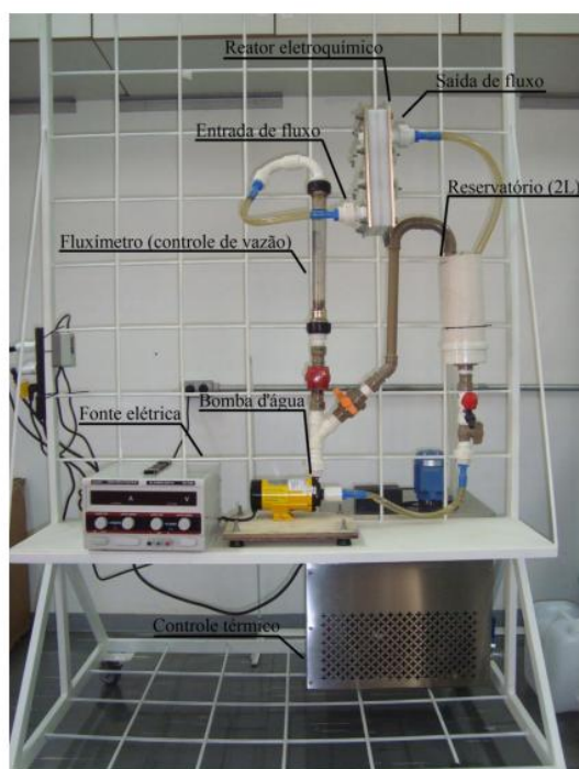
Figura 5.7 – Estrutura final do reator eletroquímico.
