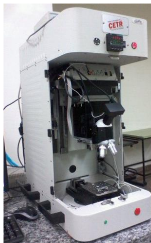
FIGURA 7: Tribômetro utilizado nos ensaios de aderência
