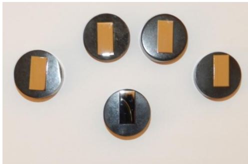
FIGURA 5: Amostras de liga de titânio (Ti 6 Al 4 V) embutidas e polidas
