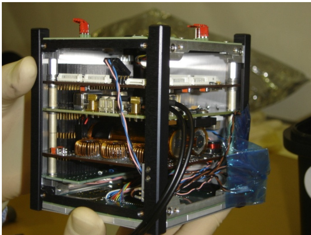
Figura 8:Arquitetura mecânica NANOSATC-BR1
