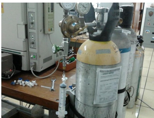
Figura 2: mecanismo de preenchimento das seringas com gás padrão
