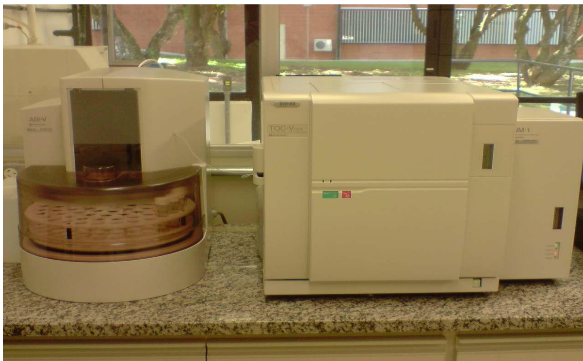
Figura 9: Analisador de Carbono Orgânico Total - modelo Shimadzu TOC-V
