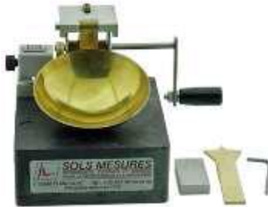
Figura 2.4 - a) Aparelho de Casagrande usado para a determinação do limite de liquidez.
