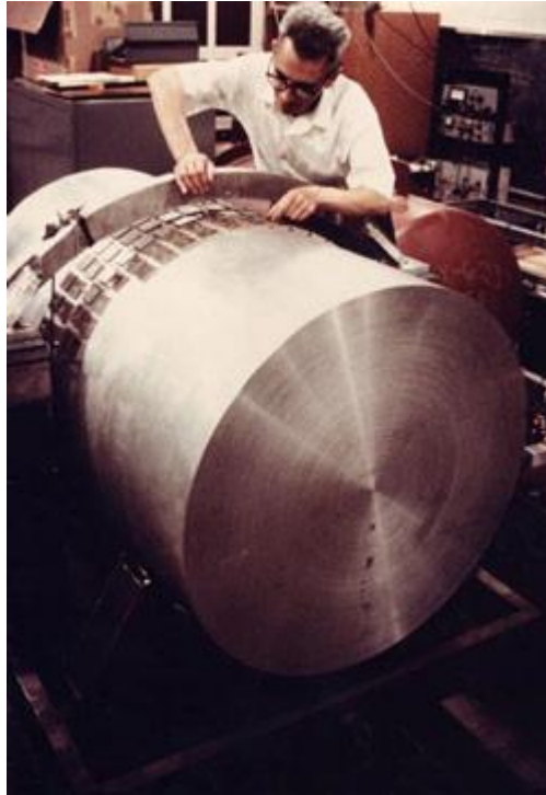
Figura 2.2 - Joseph Weber e o Detector de Massa Ressonante de Primeira Geração. FONTE: Weber, 1960.
