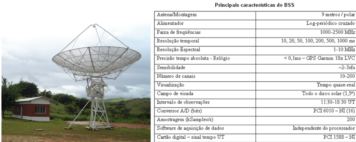
Figura 5: Imagem da antena de 9m de diâmetro do BSS instalada no novo sítio, em Cachoeira Paulista, e tabela com as principais características do instrumento.
