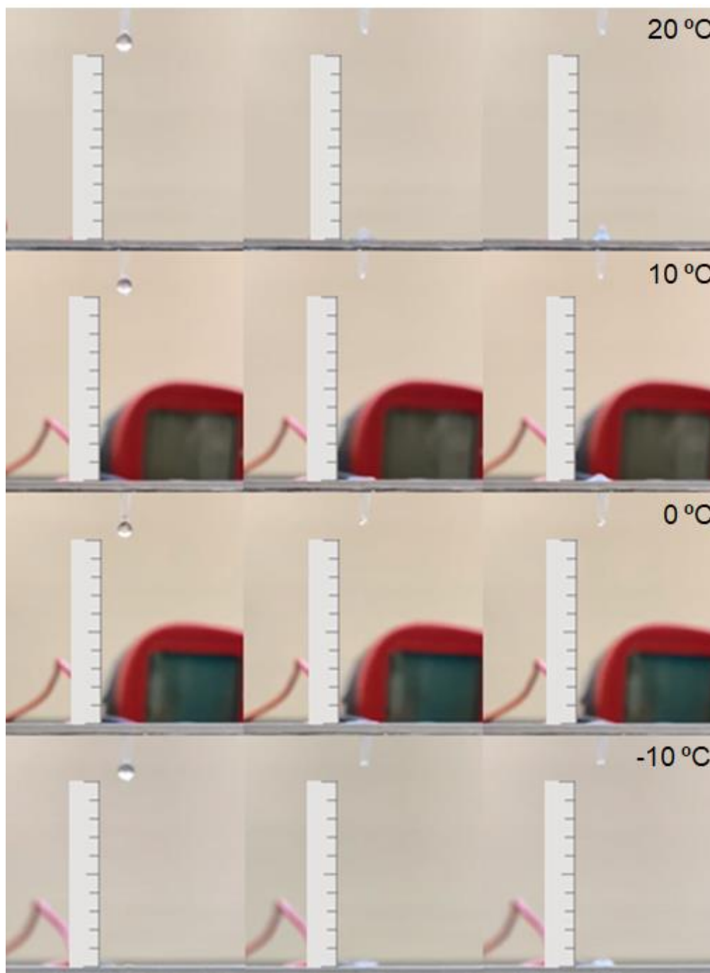
Figura 4.8 - Teste de molhabilidade dinâmica no aço.
