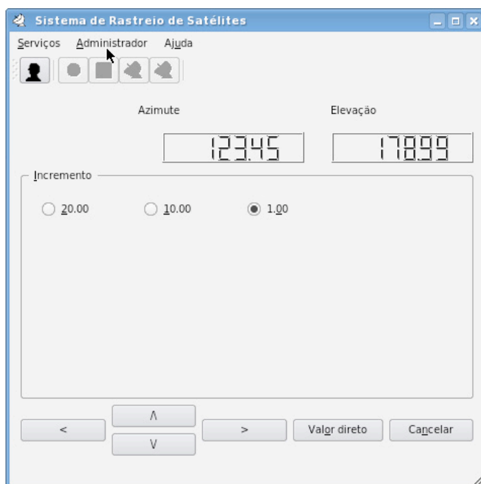
Figura 35: Tela para Movimentação manual da Antena
