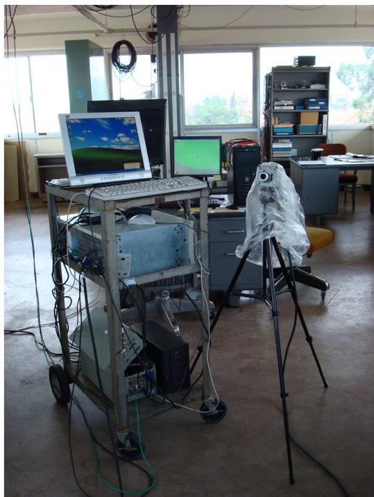
Figura 2.9 – Módulo móvel da FASTCAM 512 PCI 2k utilizado durante a campanha no verão norte-americano em Tucson, Arizona.
