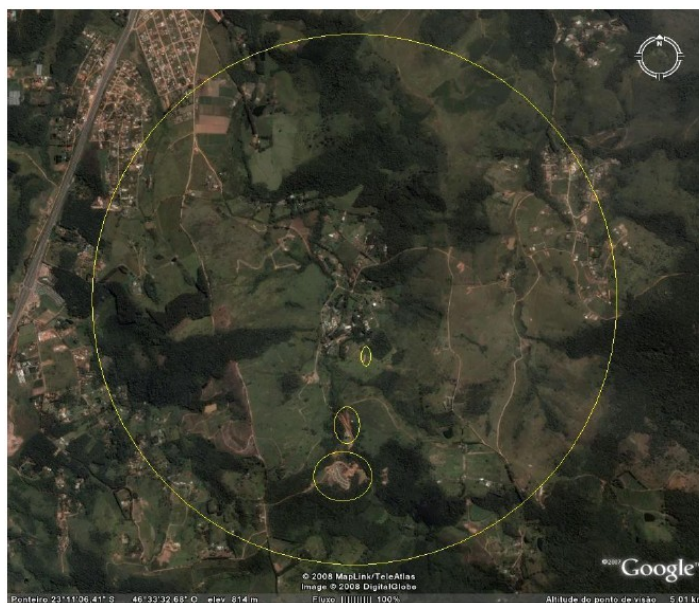
Figura 6.2 – Zona de Silêncio Elétrico. O círculo maior, com aproximadamente dois quilômetros de raio, corresponde à Zona de Silêncio Elétrico. Os outros círculos, dentro da zona, são áreas de degradação do meio ambiente.
