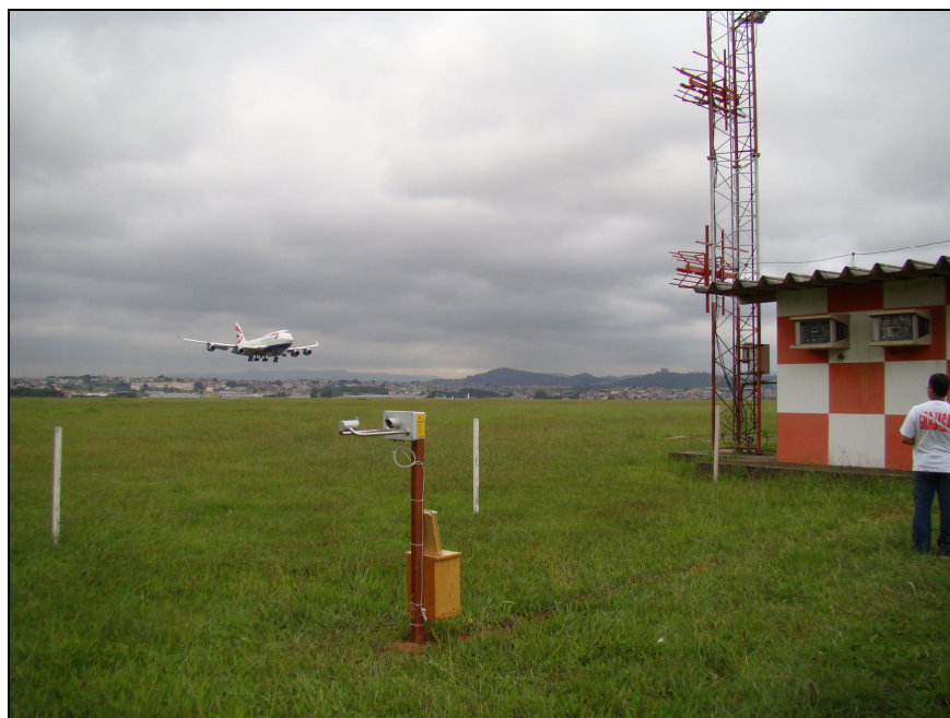
Figura 19: Local de instalação do disdrômetro
