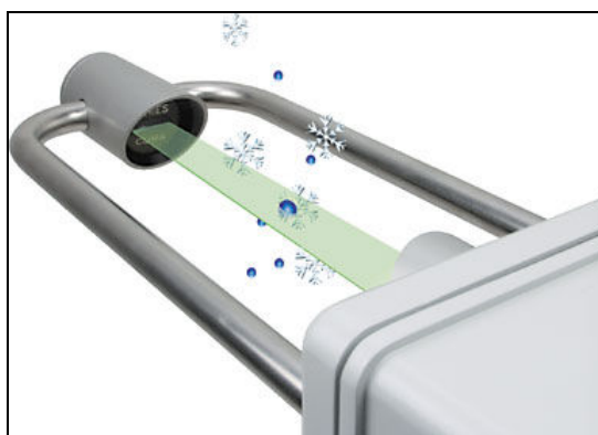
Figura12: Ilustração do funcionamento do disdrômetro.
