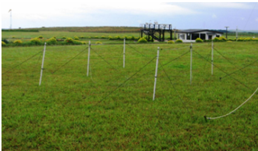
Figura 4.7: Sistema Riômetro Convencional instalado e em operação no Observatório Espacial do Sul - OES/CRS/CIE/INPE – MCT, em São Martinho da Serra, RS.
