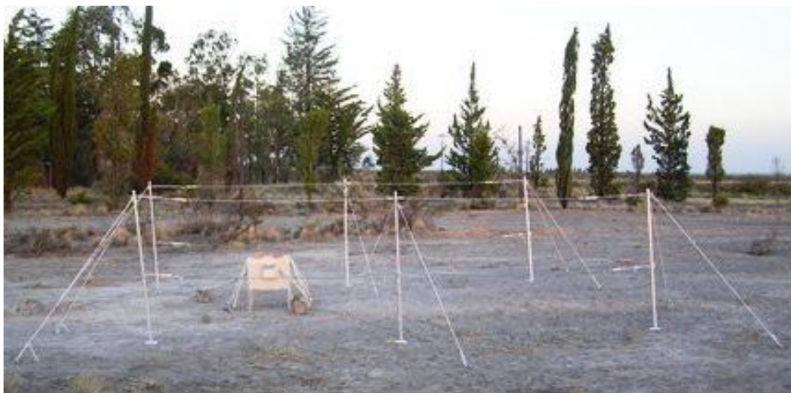
Figura 4.4: Vista da estação de Riômetros Convencionais instalados no Observatório Geofísico de Trelew, em Trelew, na Patagônia Argentina.
