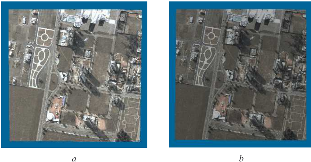
Fig. 3.6 – Imagem do solo sem (a) e com (b) correção de iluminação utilizando um ângulo de elevação do Sol de 20 graus.
