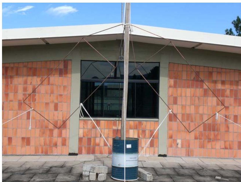
Fig. 5.3 – Primeiro protótipo de antena dipolo similar à usada no sistema LOFAR, desenvolvida e montada para testes na cobertura do prédio sede do Centro Regional Sul de Pesquisas Espaciais – CRS/CIE/INPE – MCT, em Santa Maria, RS.
