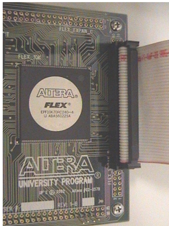
FIGURA 6.8 – Foto do conector soldado e o cabo IDE conectado.
