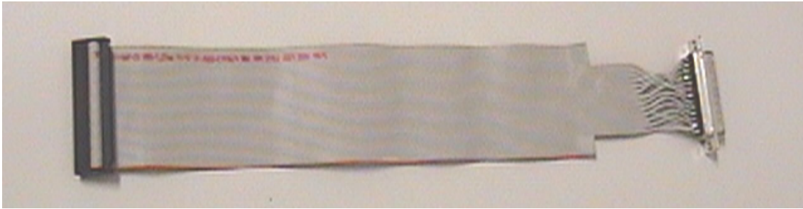
FIGURA 6.9 – Cabo IDE adaptado para uso com o kit FPGA
