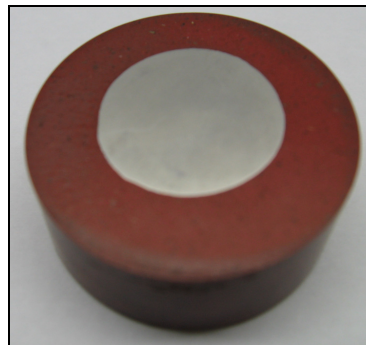
FIGURA 4.13 - Amostra envolvida com baquelite.
