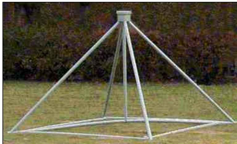
FIGURA 3.3 – Modelo de antena utilizado no LOFAR.
