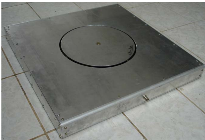
FIGURA 2.7 – Antena plana utilizada em medidas de campo elétrico.
