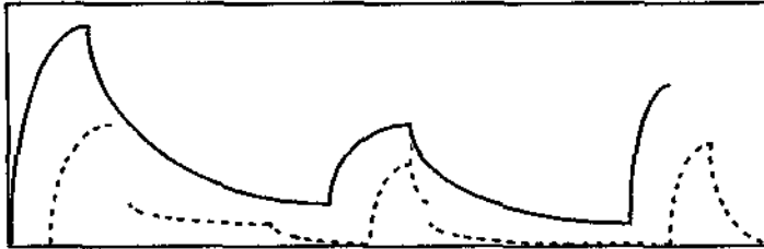
Figura 4.1.1: Modelo de gráfico DENSIDADE DE FLUXO (ordenadas) X TEMPO (abcissas). A diferença no preenchimento das linhas refere-se à representação de frequências diferentes.
