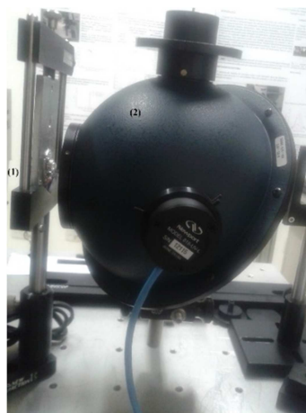
Figura 3.5: Esfera Integradora montada. (1) Lâmpada de LED com suporte; (2) Esfera Integradora.
