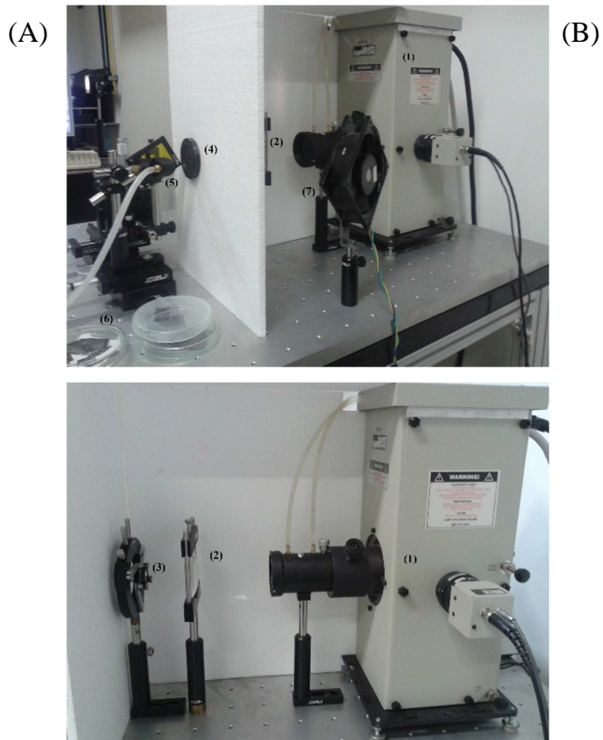
Figura 3.2: Montagem de sistemas de medição. (1) Lâmpada de Hg (Xe); (2) Lente plano-convexa; (3) Filtro de interferência; (4) Íris que regula o feixe de luz; (5) Suporte para a amostra; (6) Amostras de Silício poroso; (7) Ventilador.
