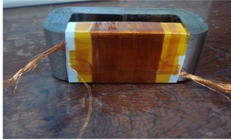
Fig. 3. Vista lateral do TP de núcleo de Metglas AMCC 100.
