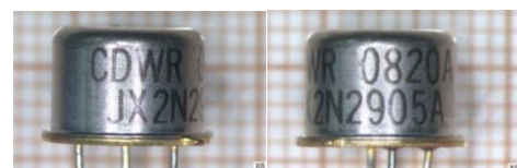
Fig. 6 – Imagens obtidas no Teste de Inspeção Visual Externa
