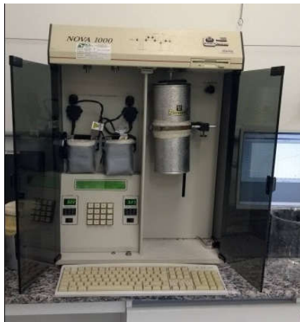
Figura 9 - Aparelho Quantachrome compreendendo duas estações: a de tratamento à esquerda; análise à direita.
