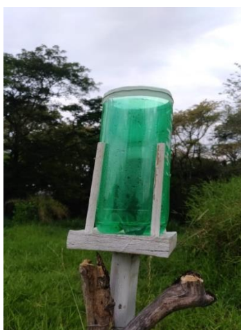
Figura 4 – Coletor de precipitação atmosférica na área externa da floresta.
