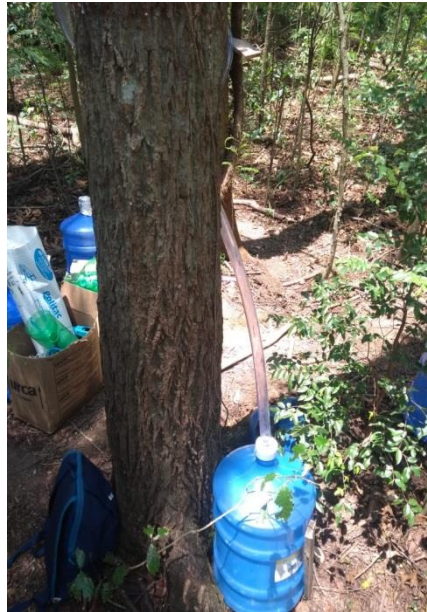
Figura 6 - Coletor de escoamento de tronco instalado na árvore Embiruçu.
