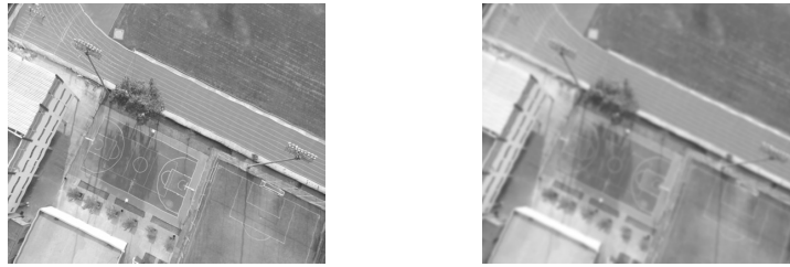
Figura 3.6 - Exemplo do efeito do filtro de Gauss em uma imagem aérea.
