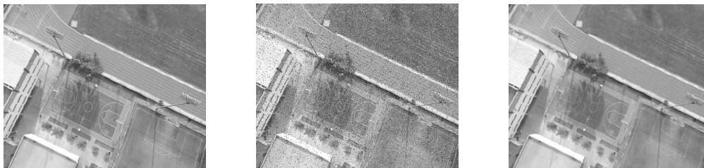
Figura 3.7 - Exemplo do efeito do filtro da mediana em uma imagem aérea com ruído.
