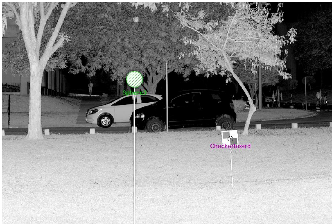
Figura 3.14 – Identificação de alvos artificiais no Faro Scene.
