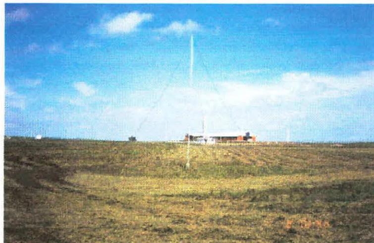
Figura 3.6 - Antena 'triangle loop' do receptor de ondas VLF/LF do OES/CRSPE-INPE.
